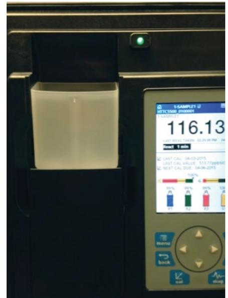
Abbildung 3 – Probentrichter
