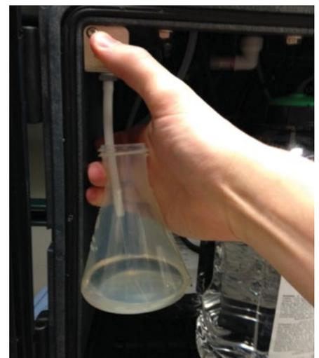
Abbildung 4 – Probenahme im 5500SC
