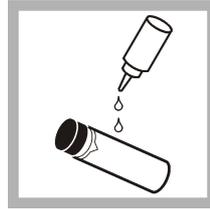
3. Tragen Sie von der Oberkante der Probenküvetten zur Unterseite hin wenig Silikonöl auf.
