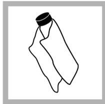
**2. Nehmen Sie die < 0,1-NTU-Ampulle.** Reinigen Sie die Ampulle mit einem weichen, fusselfreien Tuch, um Wasserflecken und Fingerabdrücke zu entfernen. Schwenken Sie die Ampulle nicht um.
