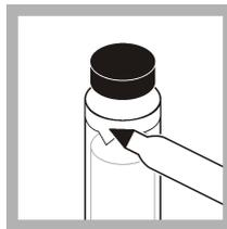
9. Notieren Sie den Wert auf dem weißen karoförmigen Feld auf der Ampulle mit einem wasserlöslichen Marker.
