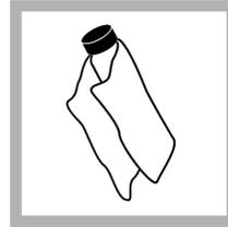
**4.** Verwenden Sie das im Lieferumfang enthaltene Ölungstuch, um das Öl gleichmäßig auf die Oberfläche der Probenküvette aufzutragen. Entfernen Sie überschüssiges Öl. Stellen Sie sicher, dass die Probenküvette nahezu trocken ist.
