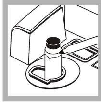
**8.** Notieren Sie den Wert. Bringen Sie eine Ausrichtungsmarkierung auf dem Markierungsband am oberen Rand der Probenküvette an.
