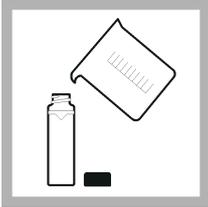
1. Spülen Sie eine saubere, leere Probenküvette zweimal mit der zu messenden Lösung und leeren Sie sie dann vollständig aus. Füllen Sie sie bis zur Linie (etwa 30 ml) mit der Probe und schrauben Sie sofort die Kappe auf die Probenküvette.
