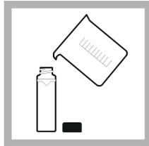
**2. Spülen Sie eine saubere Probenküvette zweimal mit Verdünnungswasser. Füllen Sie die Probenküvette bis zur Linie (etwa 30 ml) mit Verdünnungswasser und schrauben Sie sofort die Kappe auf die Probenküvette. Verwenden Sie dasselbe Verdünnungswasser, das für die Herstellung des Formazinstandards verwendet wurde.**
