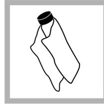
4. Verwenden Sie das im Lieferumfang enthaltene Kalibrierdatensätze, um das Öl gleichmäßig auf die Oberfläche der Probenküvetten aufzutragen. Entfernen Sie überschüssiges Öl. Stellen Sie sicher, dass die Probenküvetten nahezu trocken sind.
