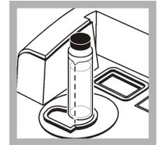
**6. Setzen Sie die Probenküvette so in den Küvetenschacht, dass das Dreieck an der Probenküvette mit der Referenzmarkierung am Küvetenschacht übereinstimmt. Schließen Sie die Abdeckung.**
