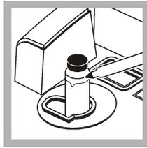
**8.** Markieren Sie die Ausrichtung, bei der der geringste Wert angezeigt wird, auf dem Markierungsband am oberen Rand der Probenküvette.
