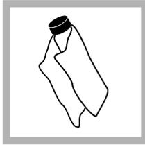
2. Reinigen Sie die Probenküvetten mit einem weichen, fussel-freien Tuch, um Wasserflecken und Fingerabdrücke zu entfernen. Schwenken Sie die Probenküvette nicht um.
