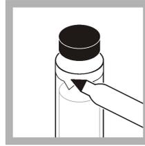
**9.** Notieren Sie den Wert auf dem weißen karoförmigen Platz auf der Ampulle mit einem permanenten Marker.
