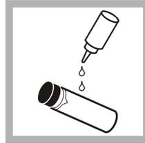
**3.** Tragen Sie von der Unterseite der Probenküvette zur Unterseite hin wenig Silikonöl auf.
