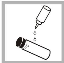
2. Tragen Sie von der Oberkante der Ampulle zur Unterseite hin wenig Silikonöl auf.
