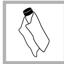
**4. Verwenden Sie das Kalibrierdatensätze, um das Öl gleichmäßig auf die Oberfläche der Ampullen aufzutragen.** Entfernen Sie überschüssiges Öl. Stellen Sie sicher, dass die Ampulle nahezu trocken ist.
