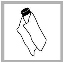
3. Verwenden Sie das Kalibrierdatensätze, um das Öl gleichmäßig auf die Oberfläche der Ampullen aufzutragen. Entfernen Sie überschüssiges Öl. Stellen Sie sicher, dass die Ampulle nahezu trocken ist.
