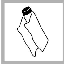
2. Reinigen Sie die Probenküvetten mit einem weichen, fusselfreien Tuch, um Wasserflecken und Fingerabdrücke zu entfernen.
