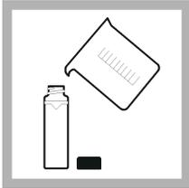
**1.** Spülen Sie eine saubere, leere Probenküvette zweimal mit Verdünnungswasser und gießen Sie es in den Abfluss. Füllen Sie die Probenküvette bis zur Linie (etwa 30 ml) mit Verdünnungswasser und schrauben Sie sofort die Kappe auf die Probenküvette. Siehe [Vorbereiten des Verdünnungswassers](#) auf Seite 23.
