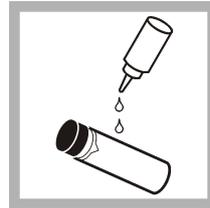
**4. Tragen Sie von der Oberkante der Probenküvette zur Unterseite hin wenig Silikonöl auf.**
