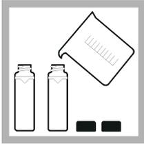
1. Spülen Sie zwei oder mehr saubere, leere Probenküvetten zweimal mit Verdünnungswasser und gießen Sie es in den Abfluss. Füllen Sie die Probenküvetten bis zur Linie (etwa 30 ml) mit gefiltertem Verdünnungswasser und schrauben Sie sofort die Kappe auf die Probenküvette. Siehe [Vorbereiten des Verdünnungswassers](#) auf Seite 23.
