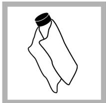
1. Reinigen Sie die Gelex-Ampullen mit einem weichen, fusselreifen Tuch, um Wasserflecken und Fingerabdrücke zu entfernen.
