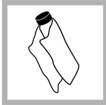
**2.** Reinigen Sie die Probenküvette mit einem weichen, fussel-freien Tuch, um Wasserflecken und Fingerabdrücke zu entfernen.
