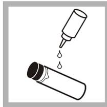
**3. Tragen Sie von der Oberkante der Ampulle zur Unterseite hin wenig Silikonöl auf.**
