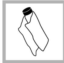
**3. Reinigen Sie die Probenküvette mit einem weichen, fusselfreien Tuch, um Wasserflecken und Fingerabdrücke zu entfernen. Schwenken Sie die Probenküvette nicht um.**
